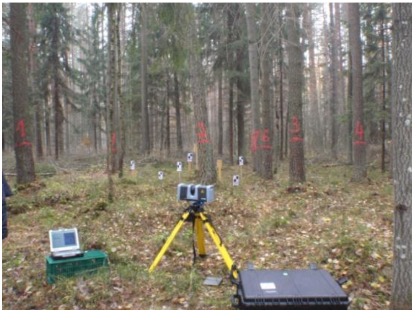
2.att. Parauglaukuma sagatavošana – lāzera skenera uzstādīšana, mērķu izvietošana un paraugkoku marķēšana
