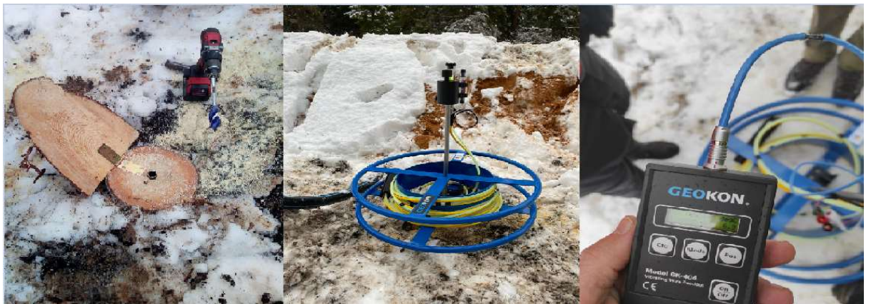
3-2.att. Profilogrāfa sistēma objektā:
