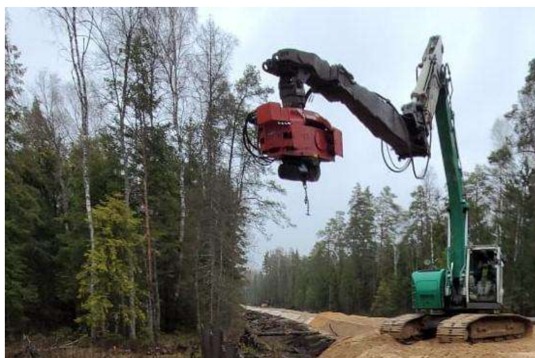
2-9.att. Kāpurķēžu ekskavators ar pievienotu hidrovibratoru
