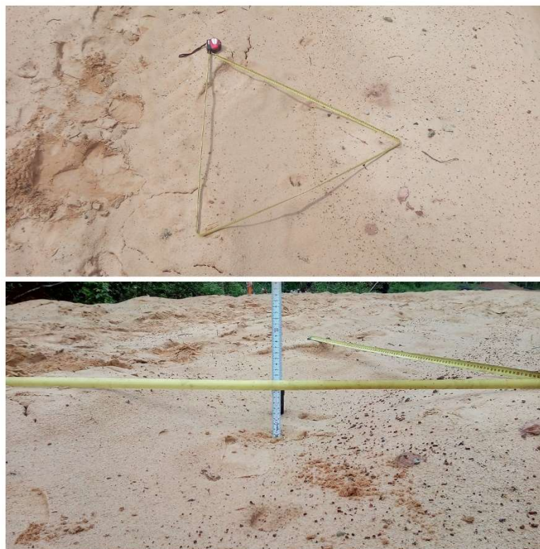
3-24.att. Smilts profila vertikālās deformācijas uzbēruma virspusē.
