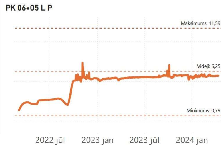
3-39.att. Grunts statiskā un dinamiskā spiediena vērtības zem ceļa konstrukcijas uzbērums ievērtējot būvtehnikas radīto slodzi.
