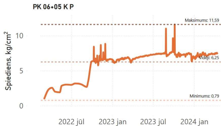
3-39.att. Grunts statiskā un dinamiskā spiediena vērtības zem ceļa konstrukcijas uzbērums ievērtējot būvtehnikas radīto slodzi.
