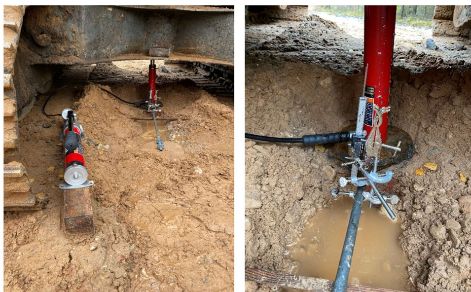
2-13.att. Pāļu slogošanas sistēma objektā.
