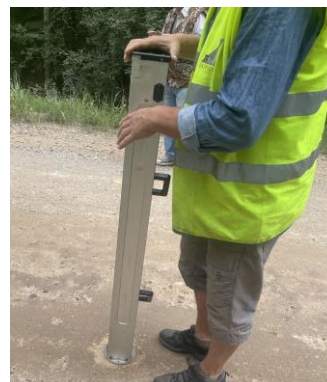
6-59. attēls. Ceļa seguma nestspējas un sablīvējuma noteikšana ar vieglo krītošā svara deflektometru LWD: (a) vadības panelis ar reālā laika aprēķina opciju; (b) testa veikšana.
