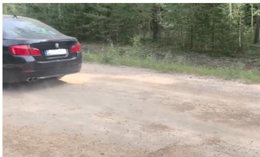
6-44. attēls. Putekļu daudzums Abermaņa meža ceļā 2. monitoringā 17.08.2023., ja automobiļa braukšanas ātrums ir 70 km/h: (a) neatputekļots ceļš; (b) ceļš atputekļots ar lignosulfonāta standarta devu; (c) ar \text{CaCl}_2 un lignosulfonāta standarta devu kombināciju; (d) ar \text{CaCl}_2 standarta devu; (e) ar \text{CaCl}_2 dubulto devu; (f) ar lignosulfonāta dubulto devu.
