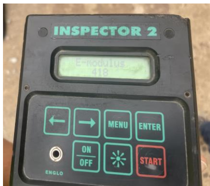
6-59. attēls. Ceļa seguma nestspējas un sablīvējuma noteikšana ar vieglo krītošā svara deflektometru LWD: (a) vadības panelis ar reālā laika aprēķina opciju; (b) testa veikšana.
