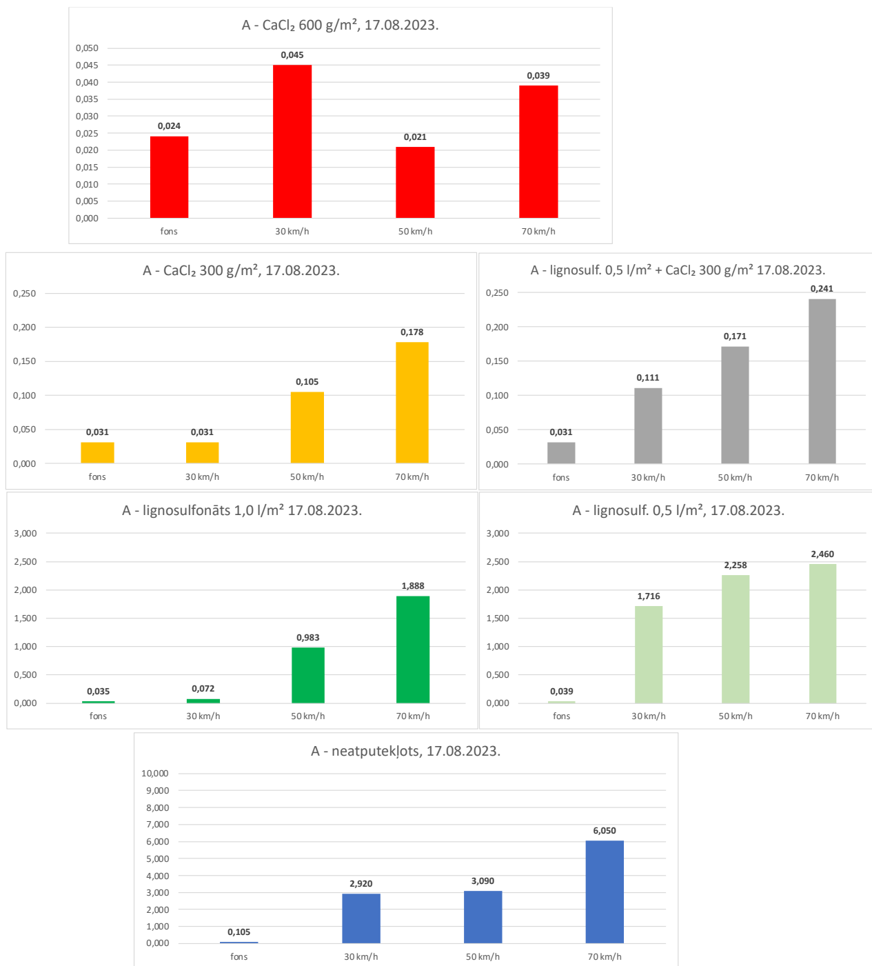
6-40. attēls. Kopsakarības automobiļa braukšanas ātrums – putekļu veidošanās intensitāte Abermaņa meža ceļā 2. monitoringā 17.08.2023.
