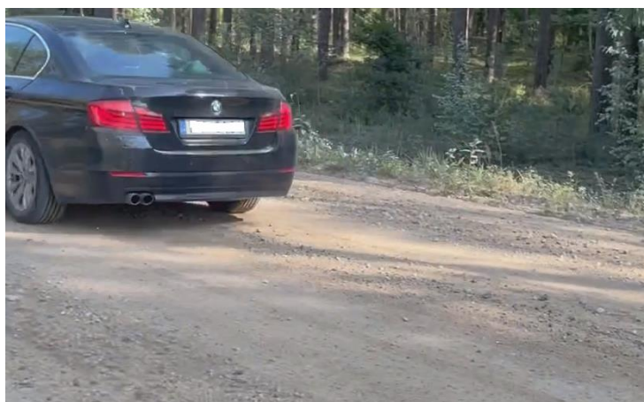
6-52. attēls. Putekļu daudzums Abermaņa meža ceļā 3. monitoringā 13.09.2023., ja automobiļa braukšanas ātrums ir 30 km/h: (a) neatputekļots ceļa posms ēnā ; (b) neatputekļots ceļa posms saulē ; (c) ar \text{CaCl}_2 un lignosulfonāta standarta devu kombināciju atputekļots ceļa posms ēnā ; (d) ar \text{CaCl}_2 un lignosulfonāta standarta devu kombināciju atputekļots ceļa posms saulē ; (e) ar lignosulfonāta dubulto devu atputekļots ceļa posms ēnā ; (f) ar \text{CaCl}_2 standarta devu atputekļots ceļa posms; (g) ar \text{CaCl}_2 dubulto devu atputekļots ceļa posms.
