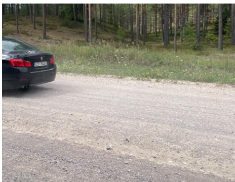
6-24. attēls. Abermaņa meža ceļš 1. monitoringā 13.07.2023., ja braukšanas ātrums ir 30 km/h: (a) neatputeķlots; (b) atputeķlots ar lignosulfonāta standarta devu.
