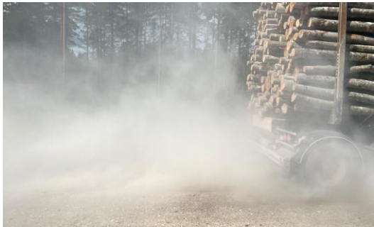
6-21. attēls. Putekļu daudzums neatputekļotajā Abermaņa meža ceļa posmā, ko rada piekraukts baļķu vedējs, braucot ar ātrumu 60 km/h: (a) skats no sāniem; (b) skats no aizmugures.
