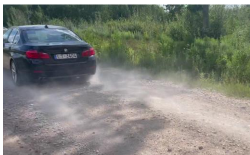
6-18. attēls. Meža ceļš Dzintari-Ābeles 1. monitoringā 13.07.2023. Braukšanas ātrums – 50 km/h: (a) neatputeķlots ceļš; (b) ar lignosulfonāta dubulto devu atputeķlots ceļš; (c) ar lignosulfonāta standarta devu atputeķlots ceļš.
