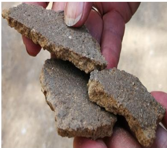
6-13. attēls. Ar lignosulfonātu atputekļotā grants seguma virsmas “garoza” ceļa 4. posmā (a) un 5. posmā (b).
