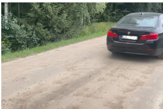
6-34. attēls. Putekļu daudzums meža ceļā Dzintari-Ābeles 2. monitoringā 17.08.2023., ja automobiļa braukšanas ātrums ir 30 km/h: (a) neatputekļots ceļš; (b) ceļš atputekļots ar lignosulfonāta standarta devu; (c) ar \text{CaCl}_2 un lignosulfonāta standarta devu kombināciju; (d) ar \text{CaCl}_2 standarta devu; (e) ar \text{CaCl}_2 dubulto devu; (f) ar lignosulfonāta dubulto devu.
