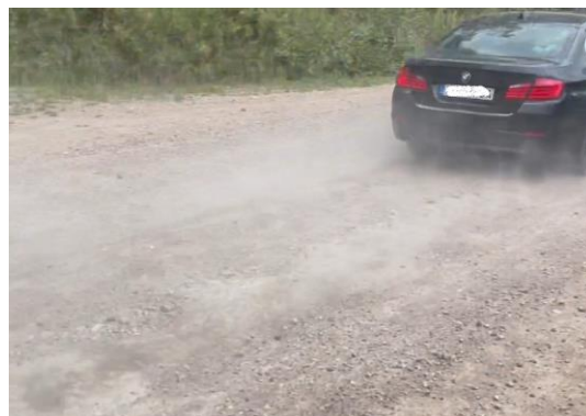
6-36. attēls. Putekļu daudzums meža ceļā Dzintari-Ābeles 2. monitoringā 17.08.2023., ja automobiļa braukšanas ātrums ir 70 km/h: (a) neatputekļots ceļš; (b) ceļš atputekļots ar lignosulfonāta standarta devu; (c) ar \text{CaCl}_2 un lignosulfonāta standarta devu kombināciju; (d) ar \text{CaCl}_2 standarta devu; (e) ar \text{CaCl}_2 dubulto devu; (f) ar lignosulfonāta dubulto devu.
