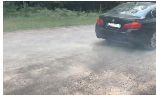
6-43. attēls. Putekļu daudzums Abermaņa meža ceļā 2. monitoringā 17.08.2023., ja automobiļa braukšanas ātrums ir 50 km/h: (a) neatputeķlots ceļš; (b) ceļš atputeķlots ar lignosulfonāta standarta devu; (c) ar \text{CaCl}_2 un lignosulfonāta standarta devu kombināciju; (d) ar \text{CaCl}_2 standarta devu; (e) ar \text{CaCl}_2 dubulto devu; (f) ar lignosulfonāta dubulto devu.
