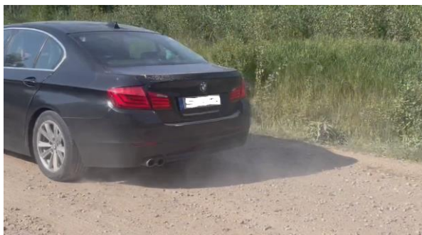
6-47. attēls. Putekļu daudzums meža ceļā Dzintari-Ābeles 3. monitoringā 13.09.2023., ja automobiļa braukšanas ātrums ir 30 km/h: (a) neatputeķlots ceļš; (b) ceļš atputeķlots ar lignosulfonāta dubulto devu; (c) ar \text{CaCl}_2 standarta devu; (d) ar \text{CaCl}_2 dubulto devu.
