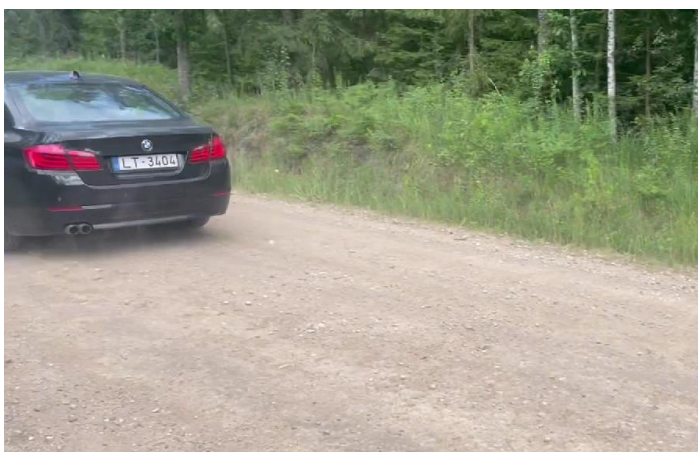
6-17. attēls. Meža ceļš Dzintari-Ābeles 1. monitoringā 13.07.2023. Braukšanas ātrums – 50 km/h. Atputeķlošanai izmantota: (a) \text{CaCl}_2 dubultā deva; (b) \text{CaCl}_2 standarta deva; (c) \text{CaCl}_2 un lignosulfonāta standarta devu kombinācija.
