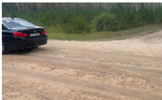
6-27. attēls. Abermaņa meža ceļš 1. monitoringā 13.07.2023., ja ātrums ir 70 km/h: (a) neatputeķlots; (b) atputeķlots ar \text{CaCl}_2 dubulto devu; (c) atputeķlots ar \text{CaCl}_2 standarta devu; (d) atputeķlots ar \text{CaCl}_2 un lignosulfonāta standarta devu kombināciju.
