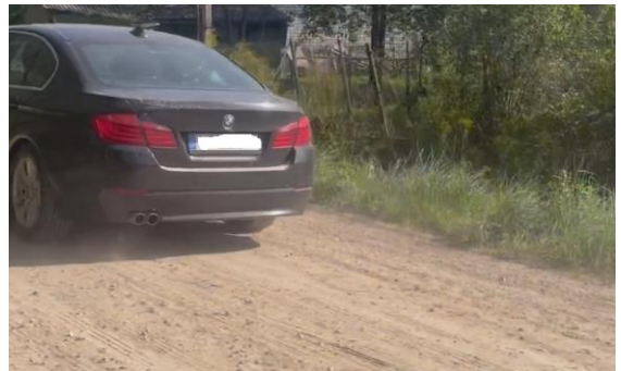
6-47. attēls. Putekļu daudzums meža ceļā Dzintari-Ābeles 3. monitoringā 13.09.2023., ja automobiļa braukšanas ātrums ir 30 km/h: (a) neatputeķlots ceļš; (b) ceļš atputeķlots ar lignosulfonāta dubulto devu; (c) ar \text{CaCl}_2 standarta devu; (d) ar \text{CaCl}_2 dubulto devu.
