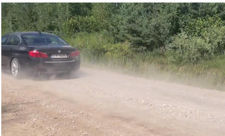
6-20. attēls. Meža ceļš Dzintari-Ābeles 1. monitoringā 13.07.2023. Braukšanas ātrums – 70 km/h: (a) neatputeķlots ceļš; (b) ar lignosulfonāta dubulto devu atputeķlots ceļš; (c) ar lignosulfonāta standarta devu atputeķlots ceļš.
