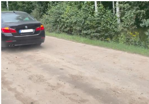
6-35. attēls. Putekļu daudzums meža ceļā Dzintari-Ābeles 2. monitoringā 17.08.2023., ja automobiļa braukšanas ātrums ir 50 km/h: (a) neatputekļots ceļš; (b) ceļš atputekļots ar lignosulfonāta standarta devu; (c) ar \text{CaCl}_2 un lignosulfonāta standarta devu kombināciju; (d) ar \text{CaCl}_2 standarta devu; (e) ar \text{CaCl}_2 dubulto devu; (f) ar lignosulfonāta dubulto devu.
