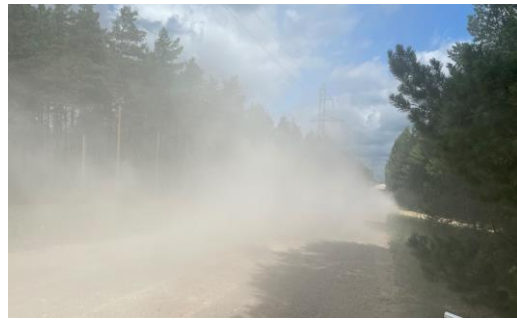
6-21. attēls. Putekļu daudzums neatputekļotajā Abermaņa meža ceļa posmā, ko rada piekraukts baļķu vedējs, braucot ar ātrumu 60 km/h: (a) skats no sāniem; (b) skats no aizmugures.
