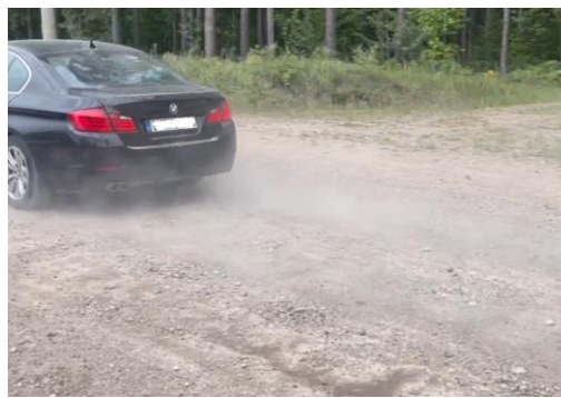
6-35. attēls. Putekļu daudzums meža ceļā Dzintari-Ābeles 2. monitoringā 17.08.2023., ja automobiļa braukšanas ātrums ir 50 km/h: (a) neatputekļots ceļš; (b) ceļš atputekļots ar lignosulfonāta standarta devu; (c) ar \text{CaCl}_2 un lignosulfonāta standarta devu kombināciju; (d) ar \text{CaCl}_2 standarta devu; (e) ar \text{CaCl}_2 dubulto devu; (f) ar lignosulfonāta dubulto devu.
