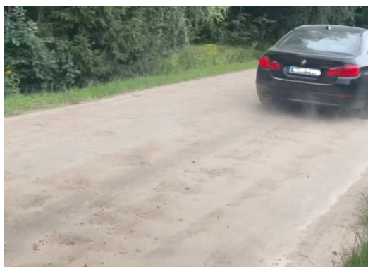
6-36. attēls. Putekļu daudzums meža ceļā Dzintari-Ābeles 2. monitoringā 17.08.2023., ja automobiļa braukšanas ātrums ir 70 km/h: (a) neatputekļots ceļš; (b) ceļš atputekļots ar lignosulfonāta standarta devu; (c) ar \text{CaCl}_2 un lignosulfonāta standarta devu kombināciju; (d) ar \text{CaCl}_2 standarta devu; (e) ar \text{CaCl}_2 dubulto devu; (f) ar lignosulfonāta dubulto devu.
