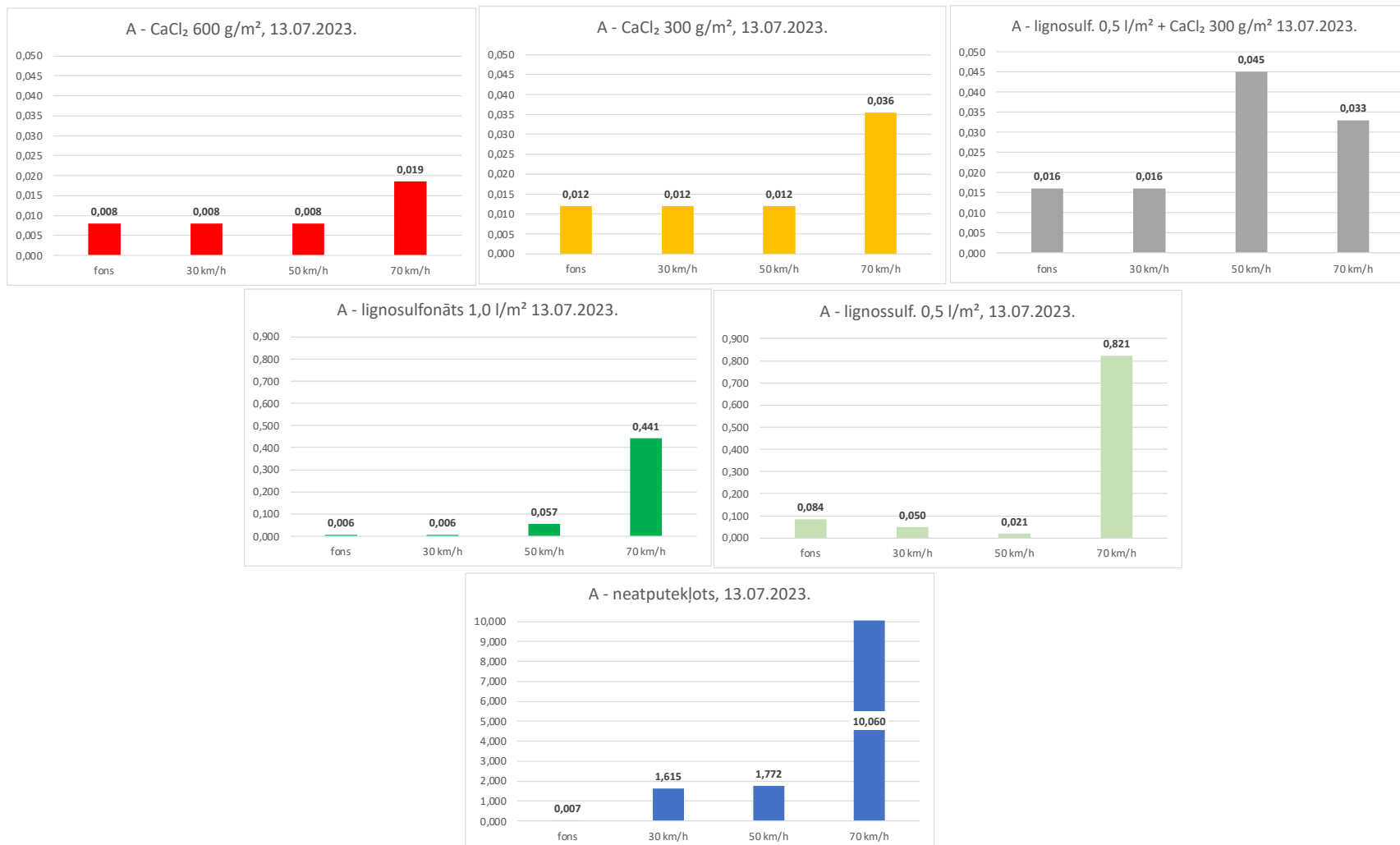
6-39. attēls. Kopsakarības automobiļa braukšanas ātrums – putekļu veidošanās intensitāte Abermaņa meža ceļā 2. monitoringā 13.07.2023.
