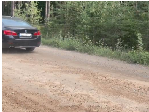
6-42. attēls. Putekļu daudzums Abermaņa meža ceļā 2. monitoringā 17.08.2023., ja automobiļa braukšanas ātrums ir 30 km/h: (a) neatputekļots ceļš; (b) ceļš atputekļots ar lignosulfonāta standarta devu; (c) ar \text{CaCl}_2 un lignosulfonāta standarta devu kombināciju; (d) ar \text{CaCl}_2 standarta devu; (e) ar \text{CaCl}_2 dubulto devu; (f) ar lignosulfonāta dubulto devu.
