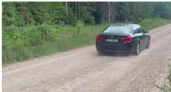
6-19. attēls. Meža ceļš Dzintari – Ābeles 1. monitoringā 13.07.2023. Braukšanas ātrums – 70 km/h. Atputeķlošanai izmantota: (a) \text{CaCl}_2 dubultā deva; (b) \text{CaCl}_2 standarta deva; (c) \text{CaCl}_2 un lignosulfonāta standarta devu kombinācija.
