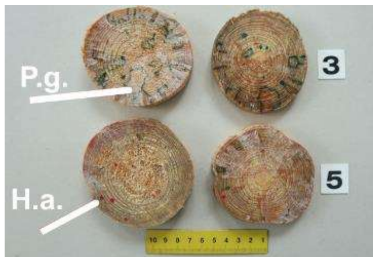
4.13. att. Lielās pergamentsēnes (P.g. - zaļš marķējums) un sakņu piepes (H. a.-sarkani punkti) dabiskās infekcijas salīdzinājums parauglaukumā 3 P (3) un 5 P (5)
