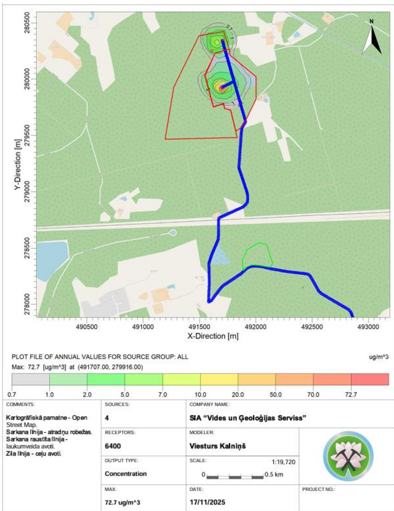
3.18.att. NO 2 gada augstāko koncentrāciju novērtējums. Paredzētā darbība un 2.maršruta alternatīva (bez fona).
