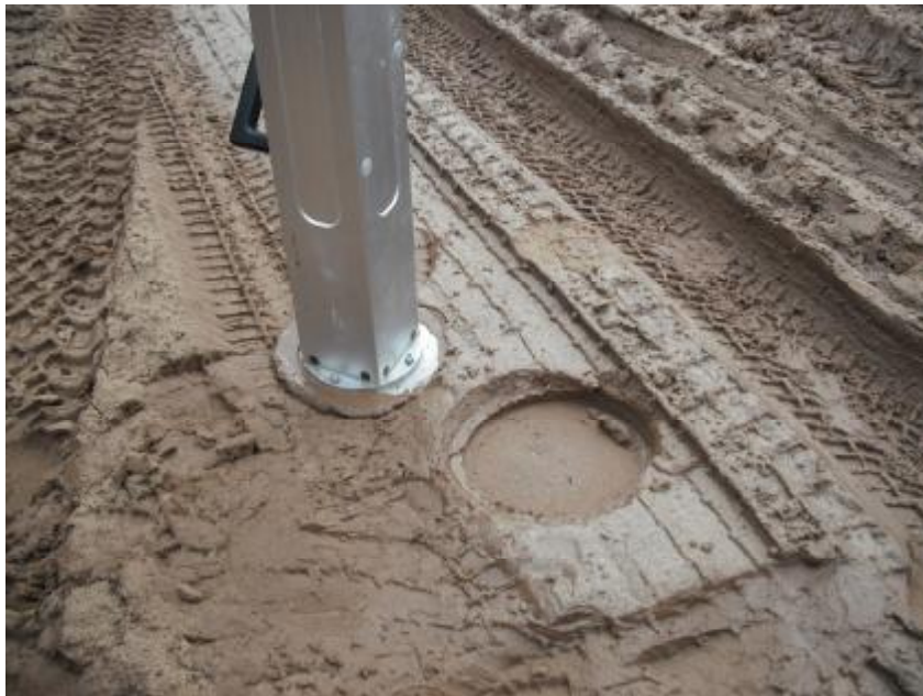
1. ATTĒLS Ceļa nestspēja (apm.40 MPa) tuvu caurbraukšanas robežai
