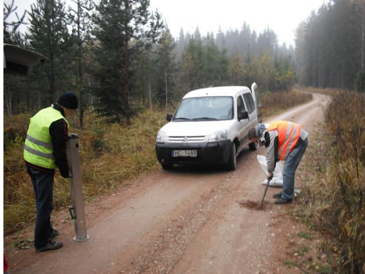
17.ATTĒLS E_v noteikšana un konstrukcijas atrakšana eksperimentālajos punktos
