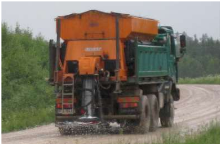
3.att. Foto: AS «Latvijas valsts ceļi» atskaite par izpildīto darbu «Grants ceļu atputekļošana»
