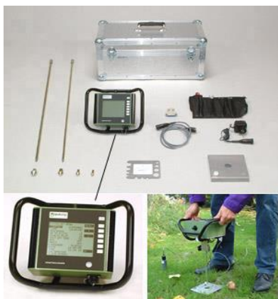
Attēls 6. Digitālais penetrolgers augsnes pretestības mērījumiem līdz 80 cm dziļumam
