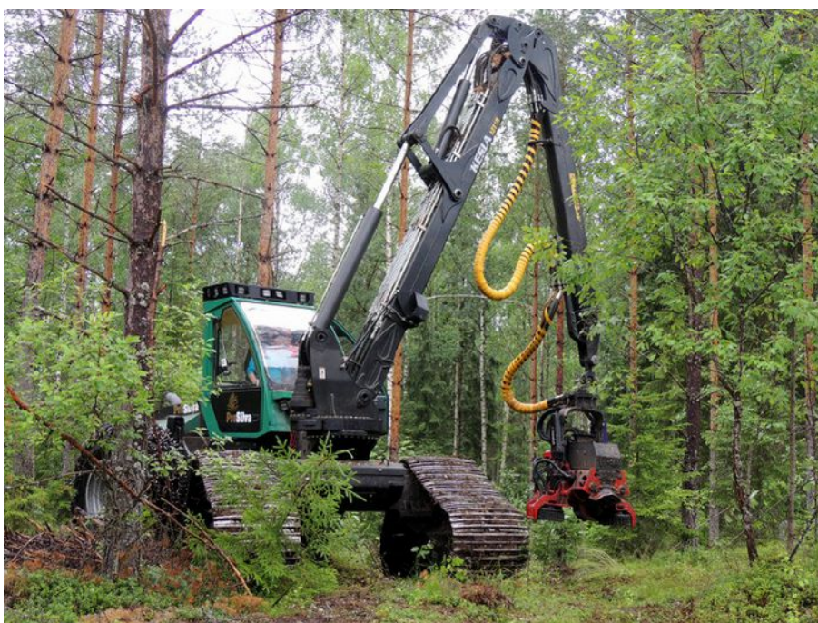
Att. 5: ProSilva S6 harvesters ar kāpurķēdēm riepu vietā uz priekšējiem tandēmiem.
