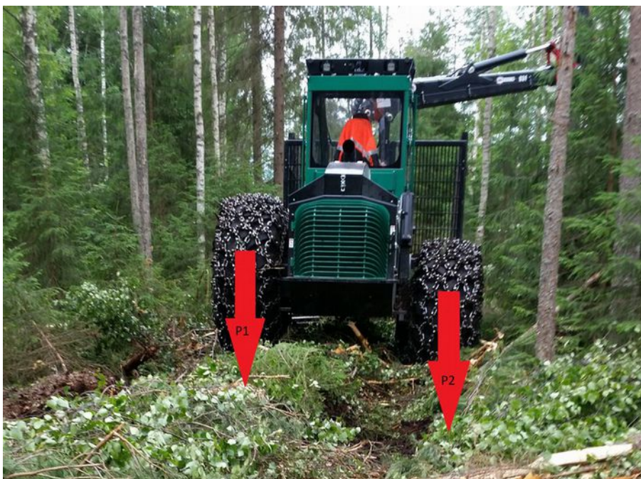
Att. 1: Pievedējtraktora ProSilva spiediens uz augsni sadalījumā pa asīm P1=P2 un P3=P4.
