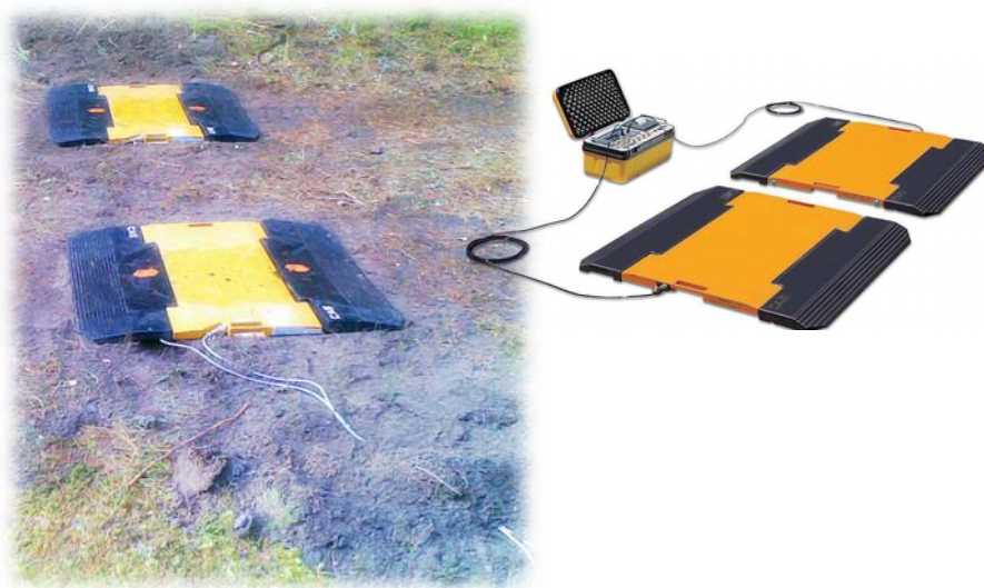
Att. 9: Piededjtraktora svēršanai izmantotie svāri CAS RW-15P, kopskats un darbam sagatavotas platformas.
