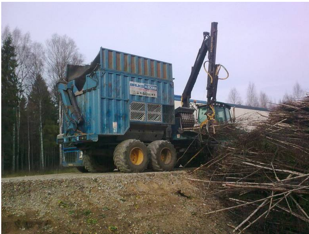
Att. 3: Šķeldotājs Bruks 1001 uz Timberjack 1410 bāzes.
