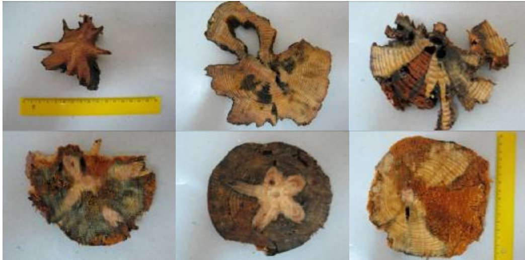
5. attēls. Analizētās koksnes ripas dažādās sadalīšanās pakāpēs.
