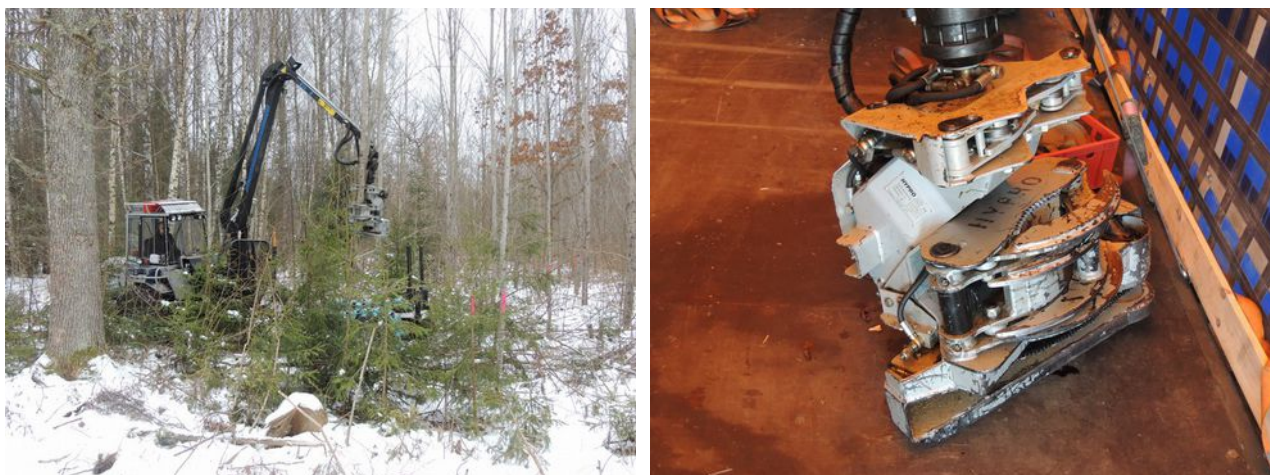
Att. 4: Vimek 610 BioCombi ar paketējošo griezējgalvu.
