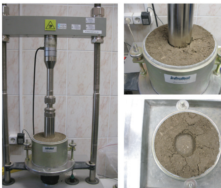
3.1 Attēls CBR tests. CBR iekārta, paraugs testēšanas laikā un paraugs pēc testēšanas
