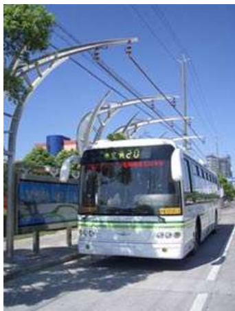
3.21. att. Superkondensatoru autobuss, kas tiek uzlādēts katrā pieturvietā [37].
