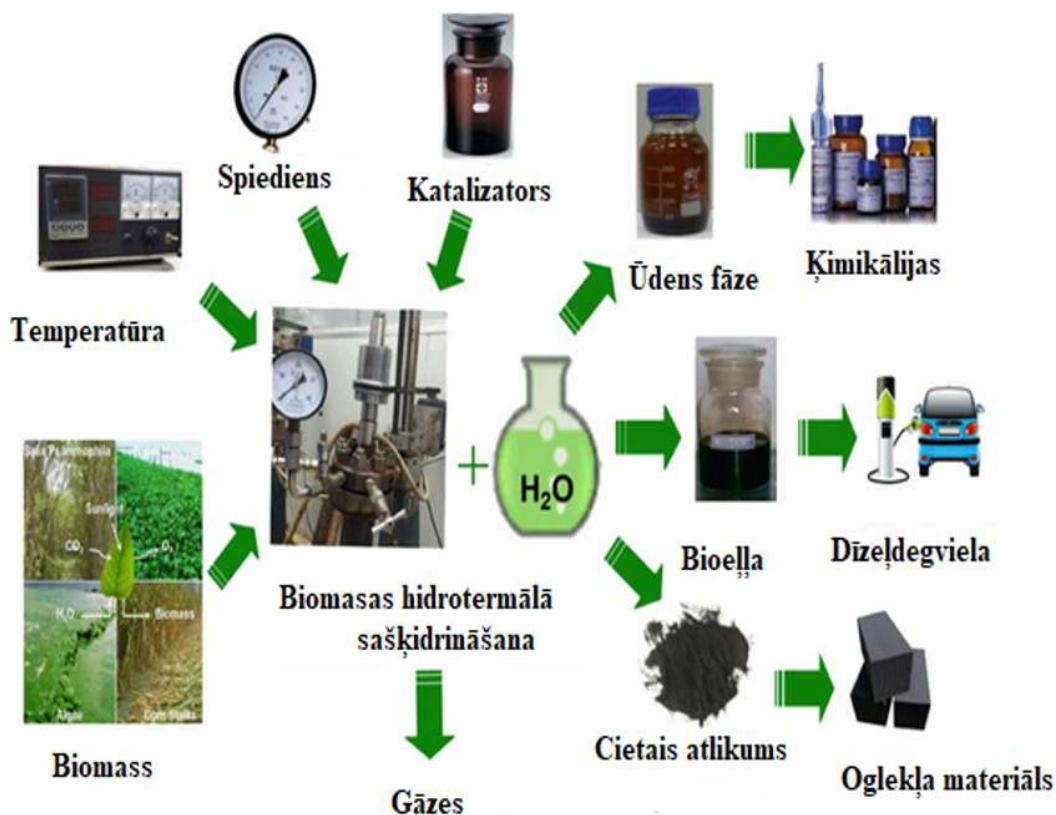
2.24. att. Biomasas hidrotermālā sašķidrināšana [61].
