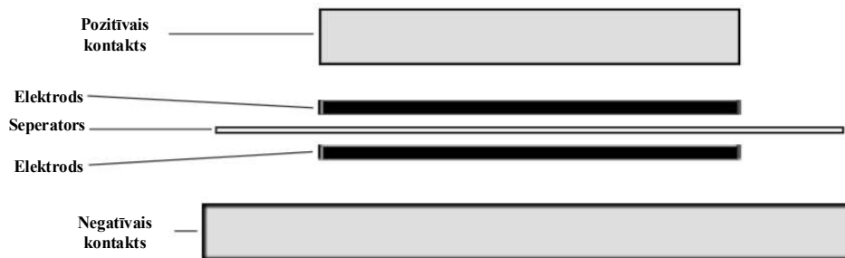
3.40. att. Uz papīra bāzēti superkondensatoru separatori.
