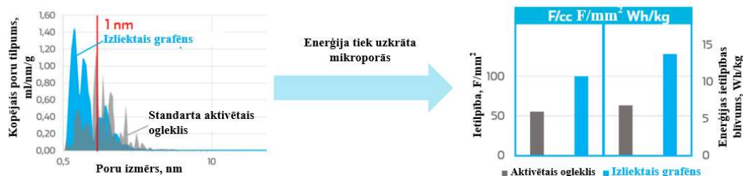
3.37. att. Grafēna pielietošana superkondensatoru parametru uzlabošanai.
