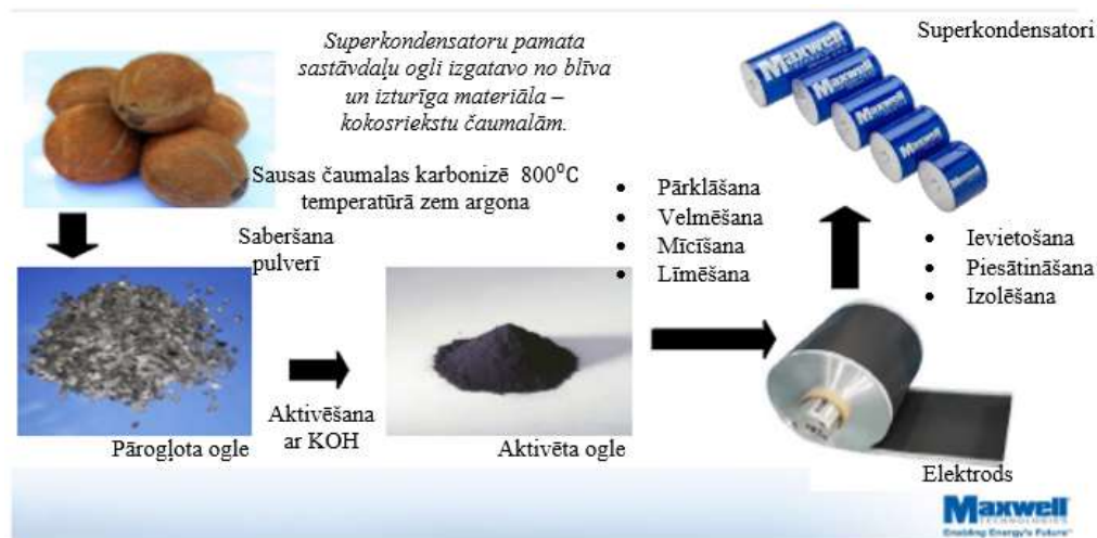
3.28. att. Superkondensatora ražošanas process.
