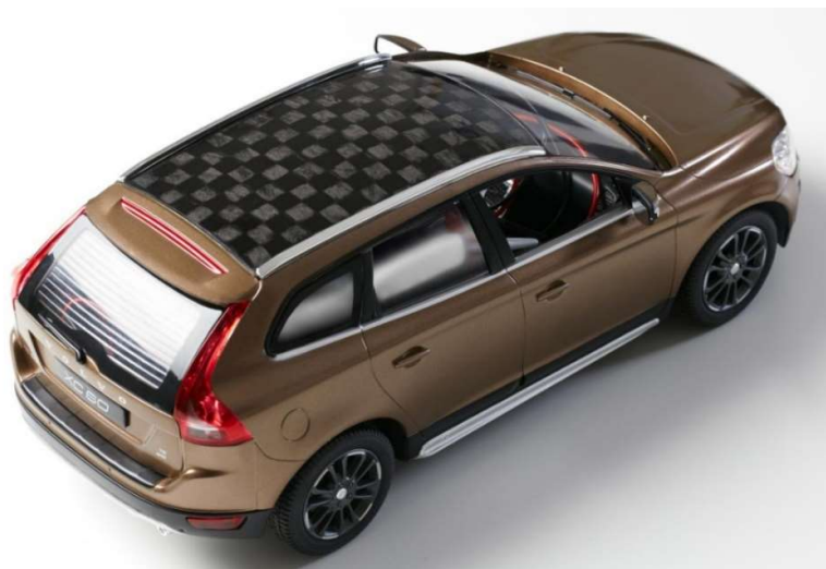
3.51. att. Volvo elektriskā auto modelis ar integrētu saules paneli un uzkrājēju automašīnas konstrukcijā.
