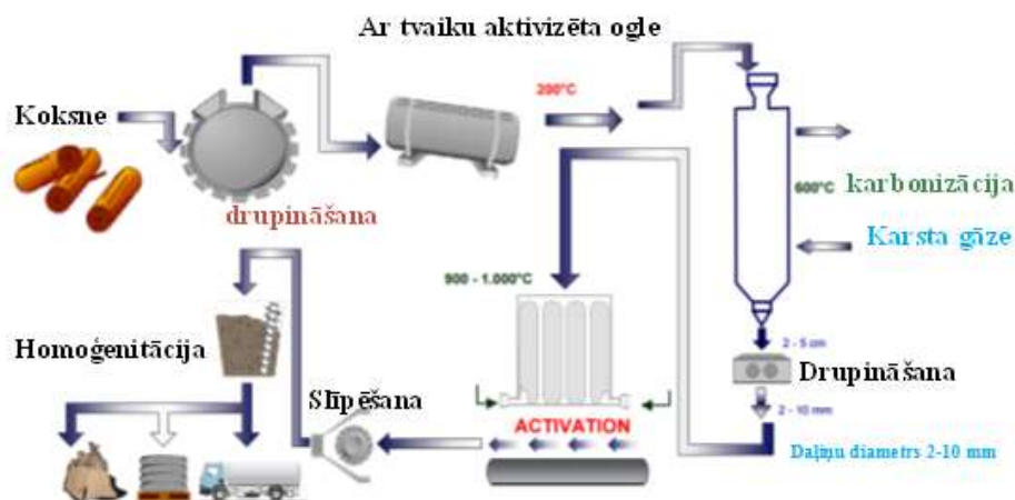
3.41.att. Aktivētās ogles iegūšanas tehnoloģiskais process [8].
