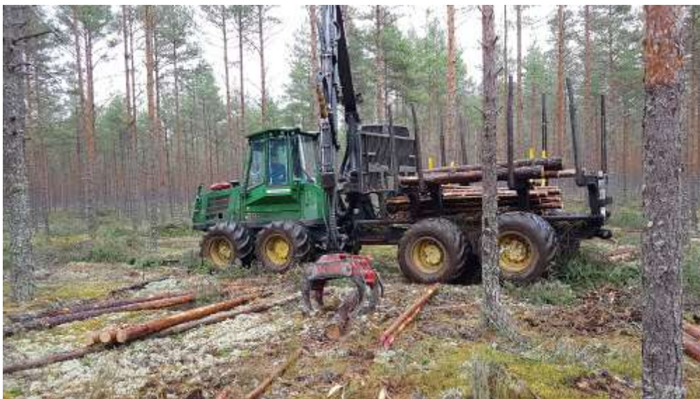
Att. 24: John Deere 1110D ECO III pievedējtraktors ar greiferi, kas aprīkots ar papildus satveršanas mehānismu.
