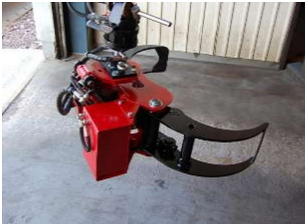
Att. 20: “Tilta” kausa (greifers ar pacelšanas funkciju) konstrukcijas un pielietojanas piemērs 9 .
