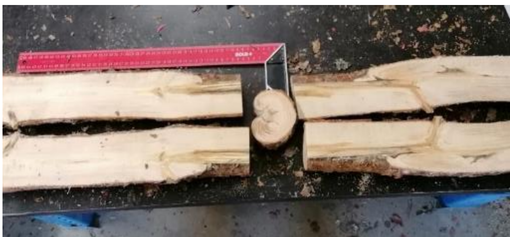
Att. 3.20. Priedes baļķa griezuma veidi: garengriezums/nogriežņi un šķērsgriezums pa bojājuma vietu
