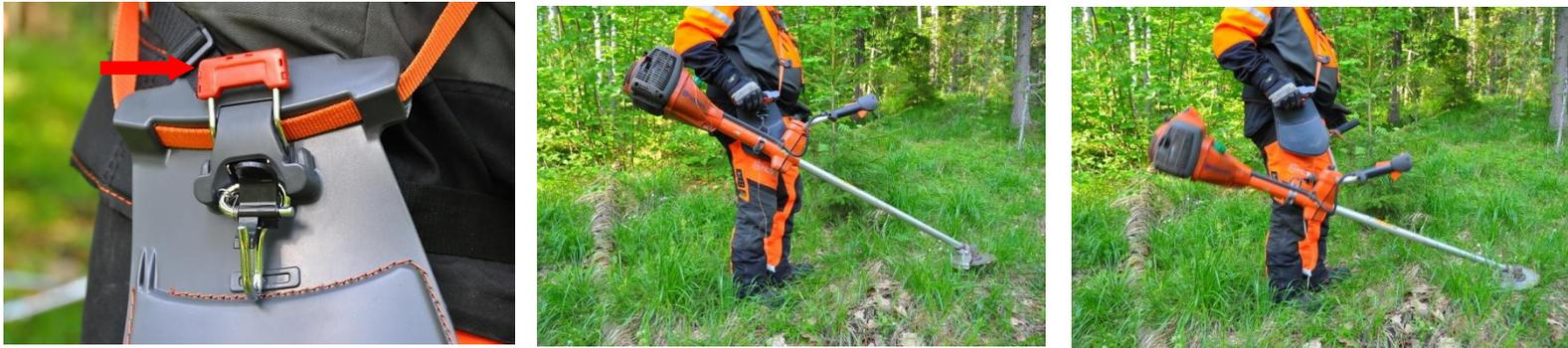
Ключ аварийного отцепления кустореза и отцепление кустореза после нажатия ключа
